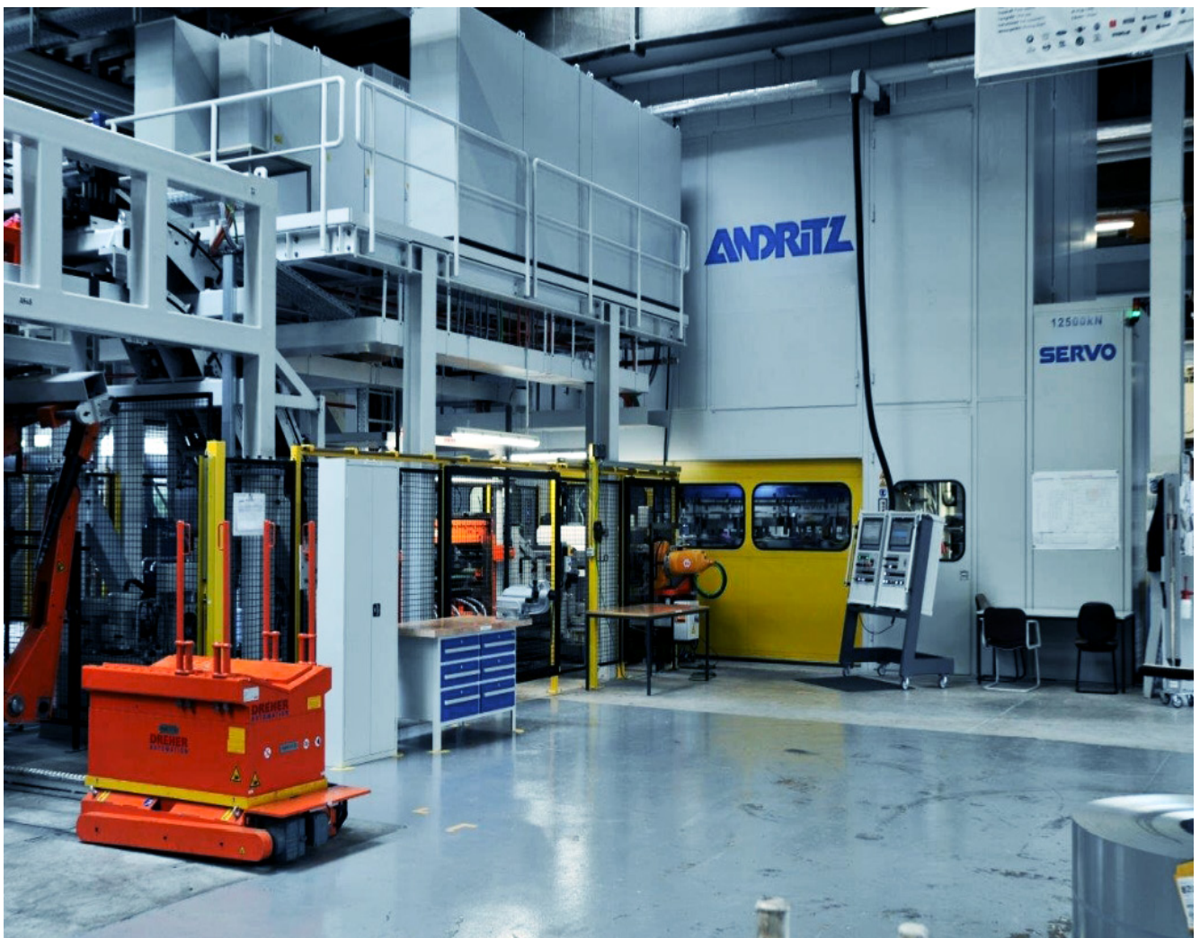
12.500 kN KAISER Servo-Transferpresse für Abgaskomponenten
