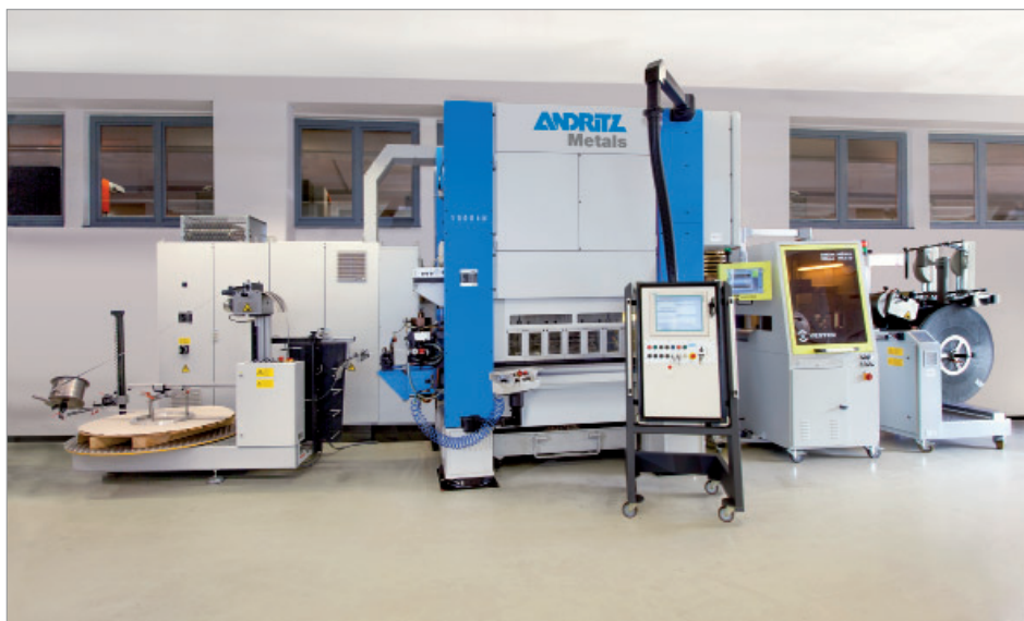
KSTU 1000-15-2G-PSR mit Bandanlage und Teilekontrollsystem
